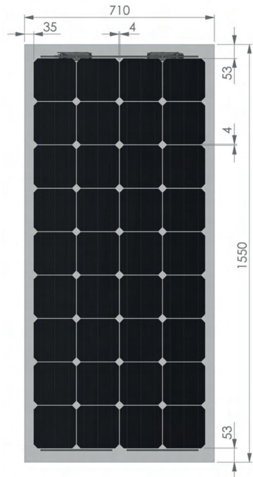
Standard Testbedingungen STC: Einstrahlung 1000 Watt/m<sup>2</sup> mit Spektrum AM 1,5 bei einer Zelltemperatur von 25 °C. Stand 02/2019.
